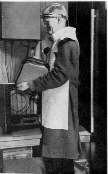
Einsetzen der Bildröhre
